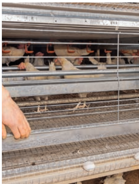
Система автоматичного збору яєць, кришка жолобу для яєць захищає яйце
