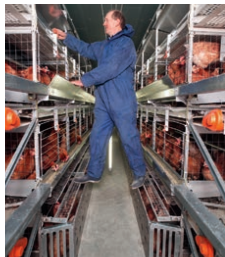
Решітка-сходинка для перевірки гнізд та поздовжній конвеєр для яєць
