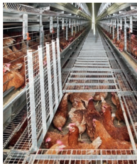
Секції решітки (1200 x 600 мм) можна дуже просто підняти для проведення інспектування
